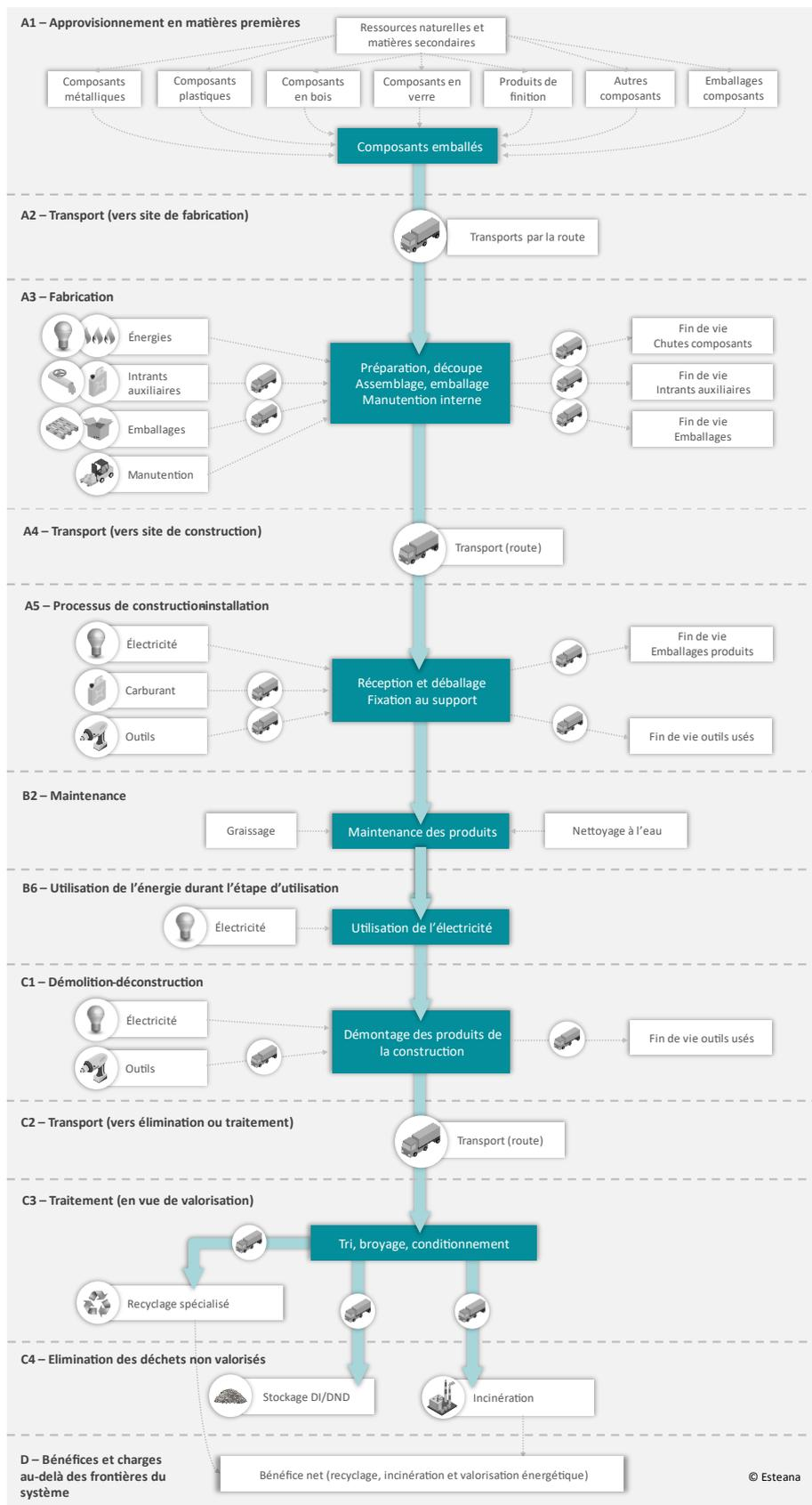
Note : ce schéma est générique, se rapporter aux contenus des sections 2 et 3 pour plus de détails.
