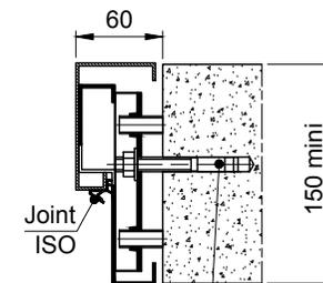
Goujon à expansion M10x85 (non fourni) au droit des trous de fixation
