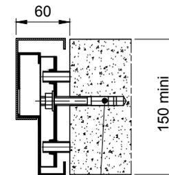
Goujon à expansion M10x85 (non fourni) au droit des trous de fixation
