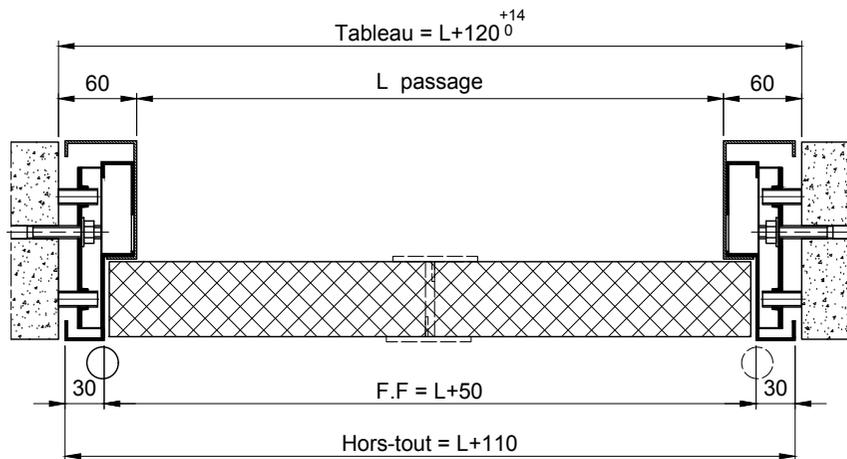
**ATTENTION: Les jambages et le linteau doivent être réalisés impérativement en béton ou en parpaings pleins.**
