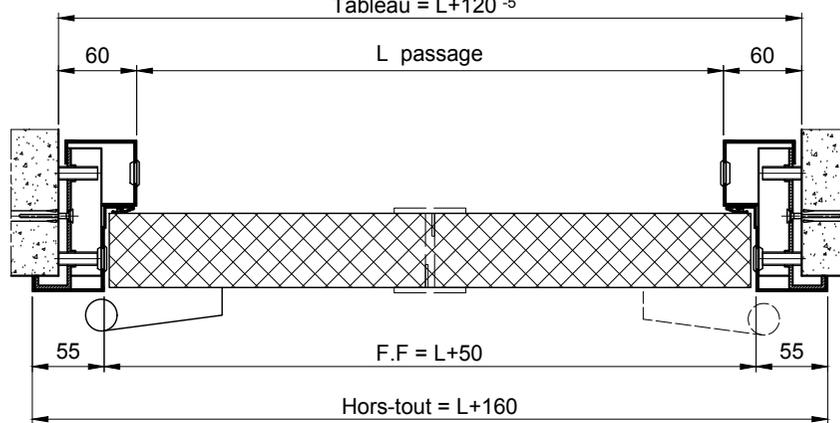
**ATTENTION: Les jambages et le linteau doivent être réalisés impérativement en béton ou en parpaings pleins.**
