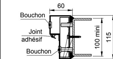
Soudure et/ou vis autoperceuse TH6.3 (non fournie)
