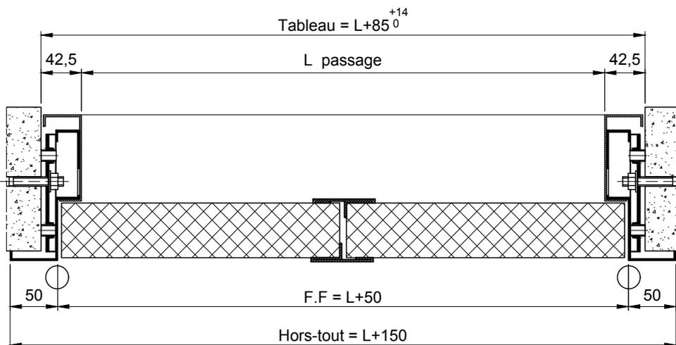
**ATTENTION: Les jambages et le linteau doivent être réalisés impérativement en béton ou en parpaings pleins.**
