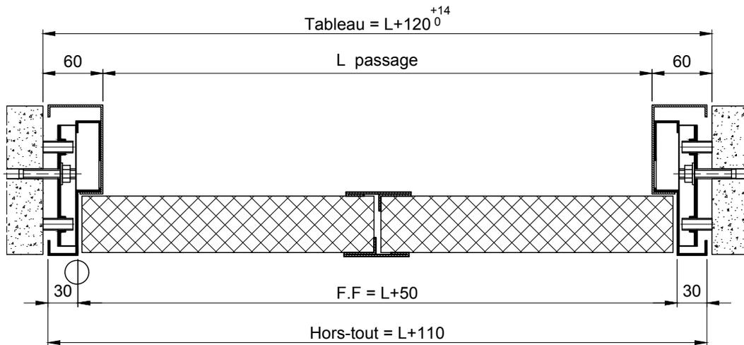
**ATTENTION: Les jambages et le linteau doivent être réalisés impérativement en béton ou en parpaings pleins.**
