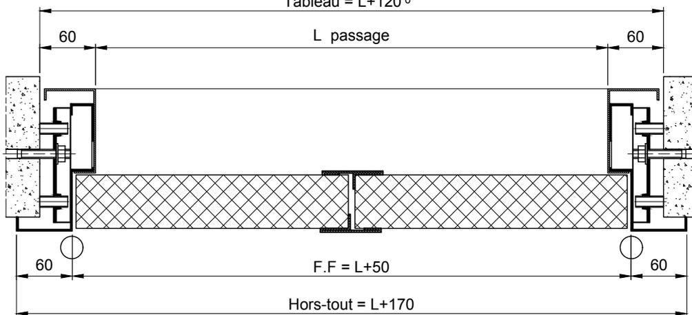
**ATTENTION: Les jambages et le linteau doivent être réalisés impérativement en béton ou en parpaings pleins.**
