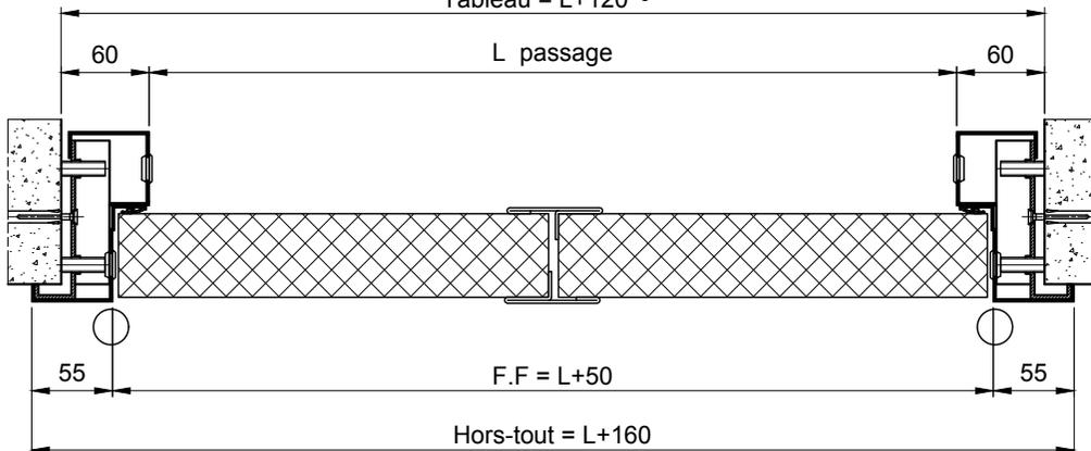
**ATTENTION: Les jambages et le linteau doivent être réalisés impérativement en béton ou en parpaings pleins.**
