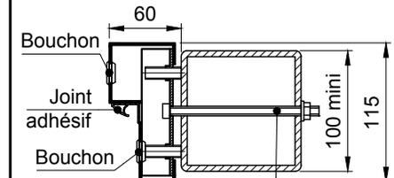
Vis CHC M8 + rondelle + écrou (non fournie) au droit des trous de fixation
