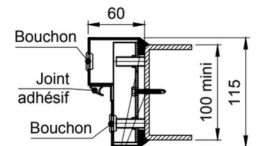
Soudure et/ou vis autoperceuse TH6.3 (non fournie)
