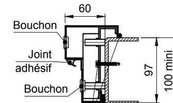
Soudure et/ou vis auto-perceuse TH6.3 (non fournie)
