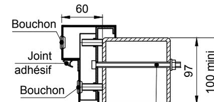
Vis CHC M8 + rondelle + écrou (non fournie) au droit des trous de fixation
